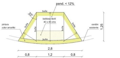
DETALLE RAMPA CON PAVIMENTO TÁCTIL
